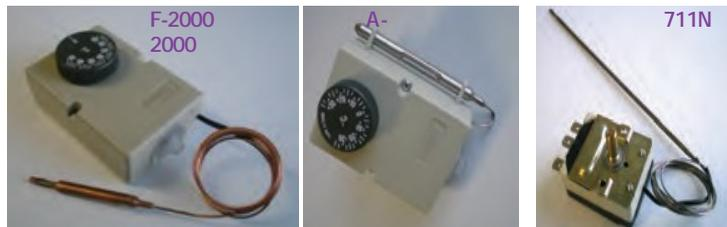
711-N : Termostato sin caja .Idóneo para mostradores frigoríficos y en el campo de la refrigeración. Características : • Contactos: En conmutación. • Características eléctricas: 16(4)A- 400V • Elemento sensible: Cobre niquelado.
